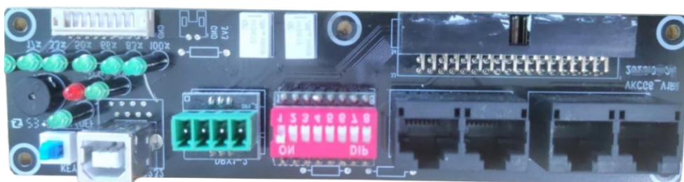
图 10-4 分体端子板配实物图正面
