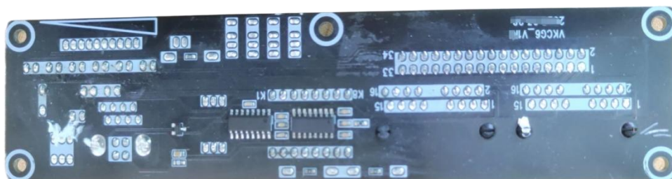
图 10-5 分体端子板配实物图反面
